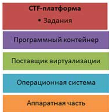
Рис. 3. Архитектурные слои CTF-платформы
